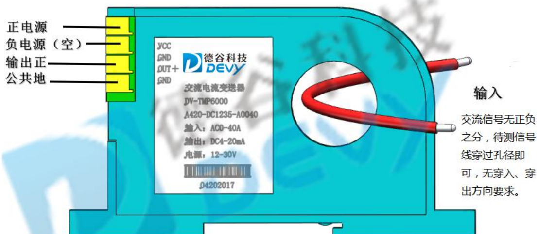
接线端子定义及穿孔接线示意图
